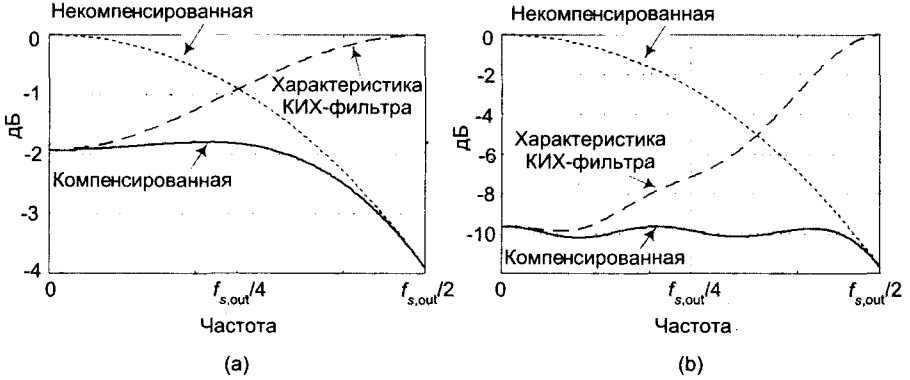
Рис. 10.24. АЧХ компенсирующего КИХ-фильтра: (а) для прореживающего ИГФ первого порядка; (б) для прореживающего ИГФ третьего порядка
