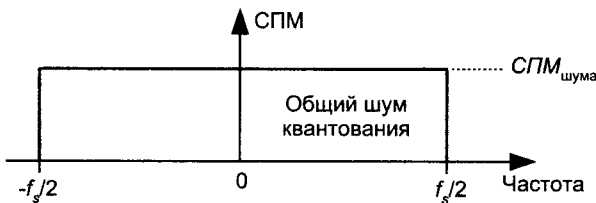
Рис. 13.17. Спектральная плотность мощности шума идеального АЦП
