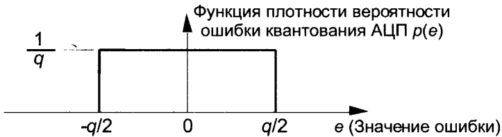
Рис. 12.3. Функция плотности вероятности ошибки (шума) округления аналого-цифрового преобразования
