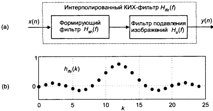
Рис. 7.34. Интерполированный КИХ-фильтр: (а) каскадная структура; (б) результирующая импульсная характеристика
