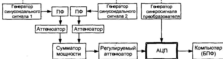
Рис. 13.25. Конфигурация аппаратуры для тестирования АЦП
