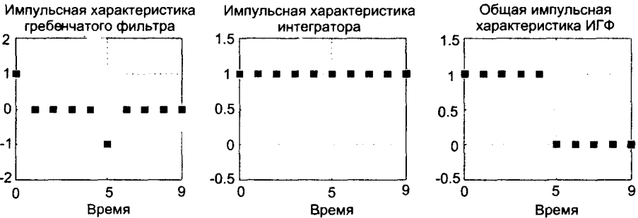
Рис. 10.15. Характеристики однокаскадного ИГФ во временной области при D = 5
